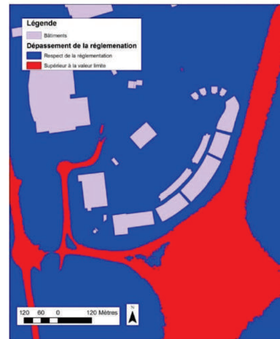
Figure 206 : Comparaison des concentrations en NO 2 à la réglementation (zone de vigilance du PPA)
